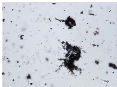
**Figura 2:** Fotografia al microscopio ottico di particolato atmosferico principalmente carbonioso. In basso a destra riportata la lunghezza corrispondente a 10 micrometri (10 millesimi di millimetro, o micron) 8 gennaio 2013 Pordenone (fonte P.Verardo). I puntini neri e gli agglomerati di puntini neri sono fuliggine, simile a quella che viene rilasciata dalla combustione non ottimale della legna o dalle vetture Diesel.
