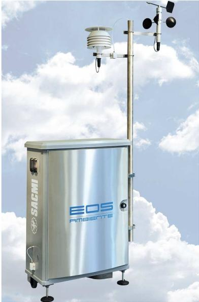
Gli strumenti necessitano di una manutenzione annuale. Per il Naso Elettronico EOS507 è necessaria una verifica dei sensori ed eventuale sostituzione. Tali accertamenti vengono eseguiti dalla ditta costruttrice.
