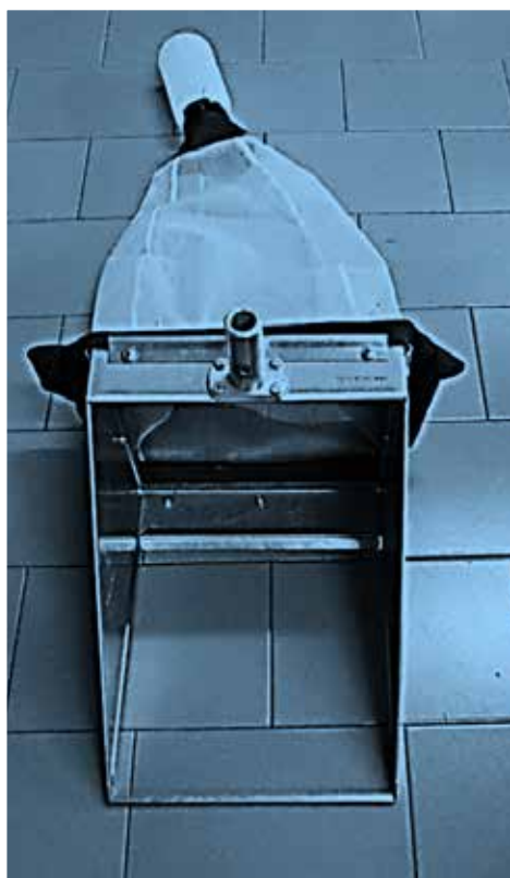
Retino immanicato con bicchiere di raccolta, utilizzato per il campionamento dei macroinvertebrati.
