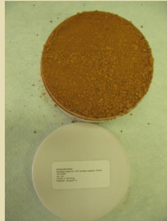
Homogeniziran cilindrični vzorec
