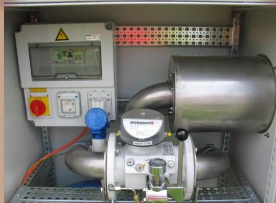
V Dobovi in na dvorišču IJS v Ljubljani poteka vzorčevanje z zračnimi črpalkami, ki skozi aerosolne filtre prečrpajo od 100 000 m<sup>3</sup> do
