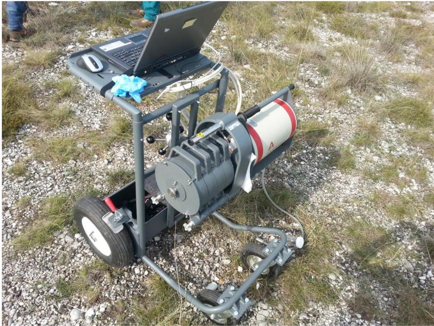
**Figura 5.7.** Configurazione per la misura di spettrometria gamma in campo con i collimatori
