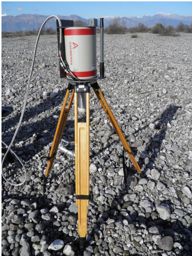
Figura 4.4. Misura di spettrometria gamma *in situ*
