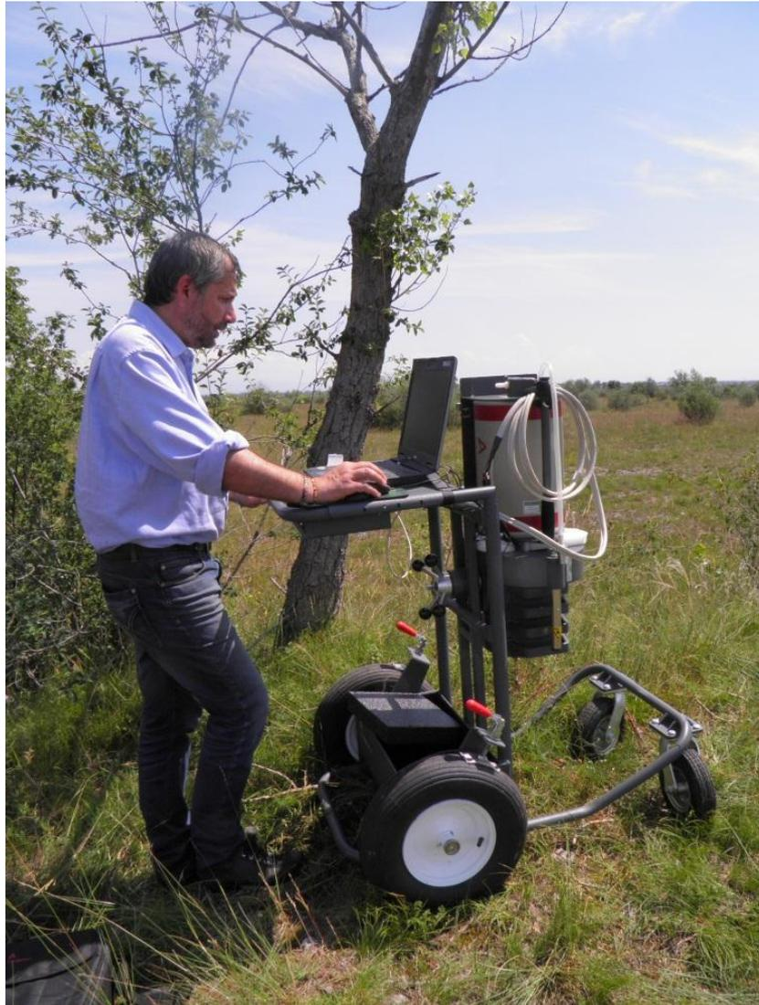
**Figura 4.8.** Spettrometria gamma *in situ* con collimatori
