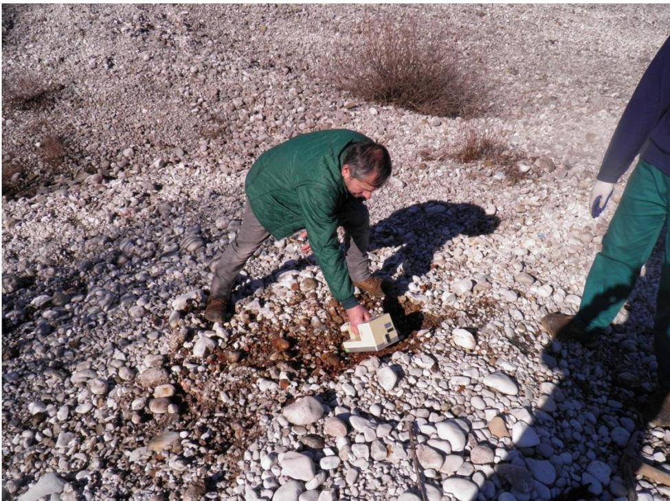
**Figura 4.2.** Misura di livello di radiazione dopo asportazione di un campione di suolo superficiale
