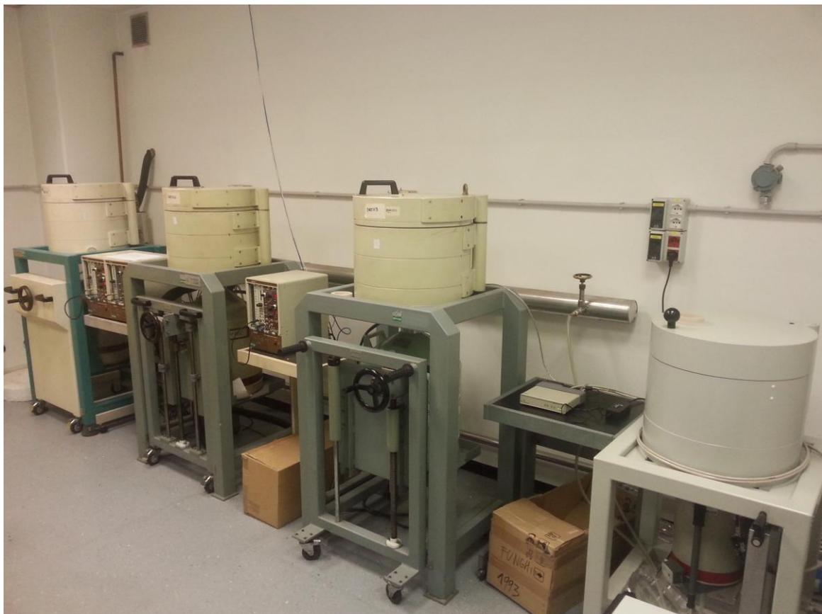
**Figura 4.6.** Laboratorio di spettrometria gamma SOS Fisica Ambientale: pozzetti contenenti i rivelatori al Germanio
