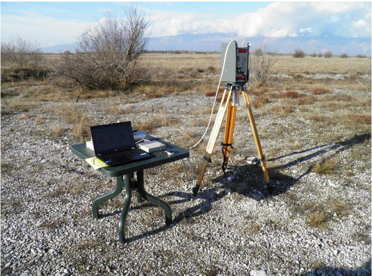
Figura 4.7. Spettrometria gamma *in situ* senza collimatori
