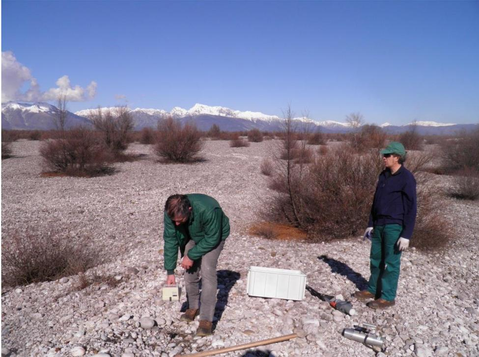
**Figura 4.1.** Misura di livello di radiazione sulla sommità di un rilievo mediante strumento Berthold
