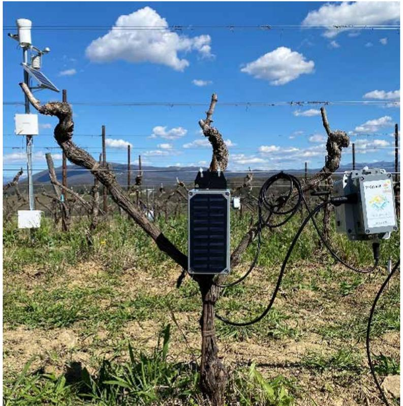
Sensoristica installata nel vigneto della azienda agricola Specogna (Corno di Rosazzo, UD). I sensori in foto misurano il flusso idrico della pianta e la disponibilità idrica a livello radicale.
