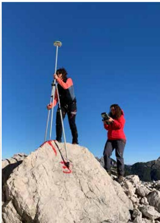
Rilievi topografici con GNSS di precisione.
