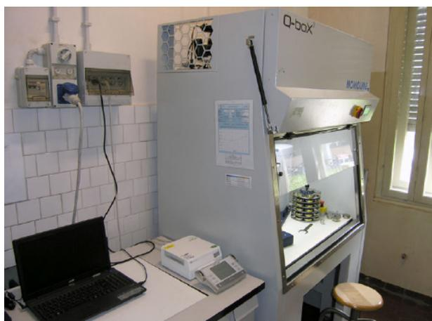
Cabina per la pesatura dei filtri di PM<sub>x</sub>
