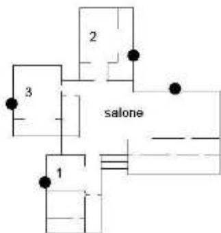
Posizione dei ventilatori installati
