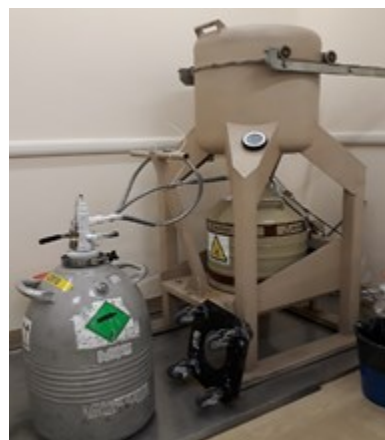
fig. 3: Sistema spettrometrico HpGe del laboratorio di ASUGI
