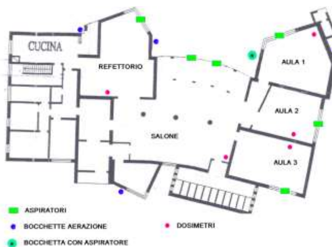
Posizione degli aspiratori installati
