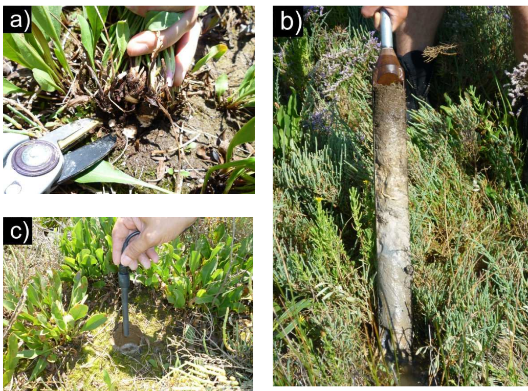
Figura 1.6 - a) separazione della parte aerea di un esemplare di Limonium narbonense ; b) prelievo della parte epigea tramite sgorbia; c) misura dell'ossigeno disciolto.
