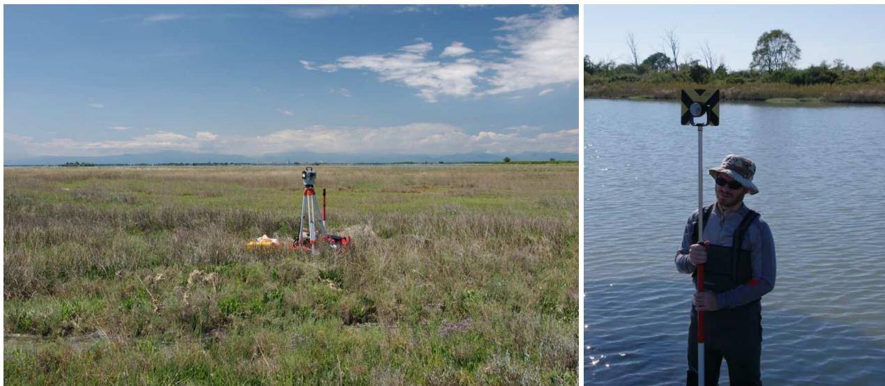
Figura 1.2 – Diverse fasi del rilievo con stazione totale: a sinistra stazione montata sul punto stazione, a destra rilievo dei punti del profilo con prisma montato su asta telescopica.
