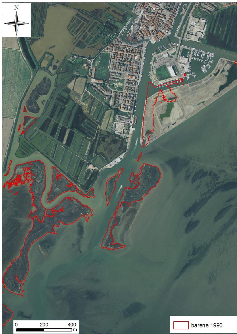
Fig. 20 - Foto aerea del 2006 dell'area di Marano Lagunare con il perimetro delle barene del 1990 (in rosso). Appare evidente, in alto nella foto, l'eliminazione di una barena di circa 4 ha, Alcuni siti appaiono sottoposti ad azione erosiva da parte del moto ondoso indotto dai venti
