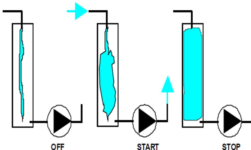
**Figura 6.** Schema di campionamento con pompa a depressione
