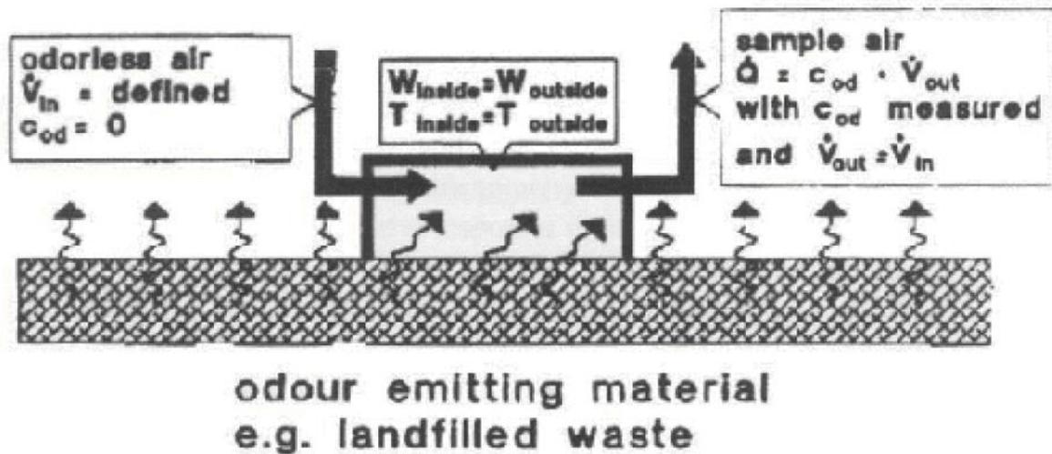
**Figura 8.** Schema di funzionamento di una cappa per il campionamento da superfici areali passive
