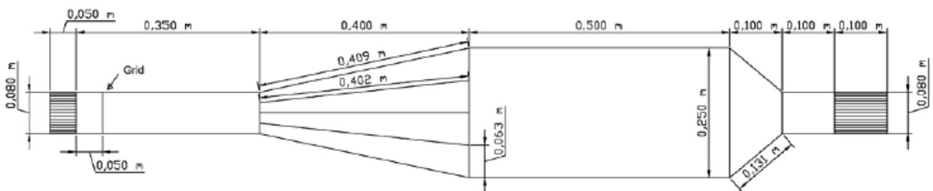
**Figura 9.** Esempio di pianta di una wind tunnel
