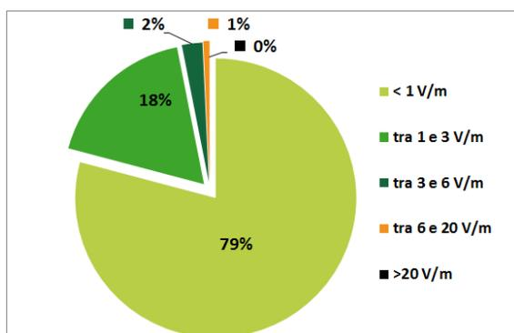
Nel grafico è riportata la suddivisione delle misure effettuate nel corso del 2020 in classi di campo elettromagnetico.
