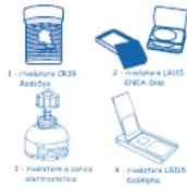
Fig. 1 - Rivelatori passivi per la misura del radon
