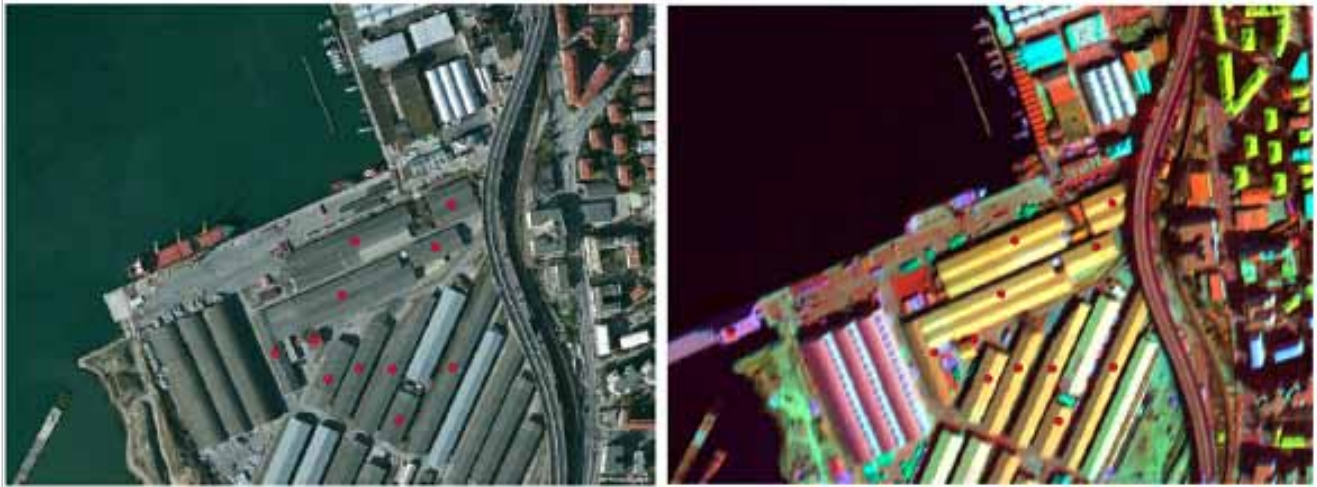
Figura 4: primi risultati dell'interpretazione dei dati di telerilevamento multispettrale su bersaglio noto (a sinistra immagine RGB e bersagli noti (marker rossi), a destra immagine multispettrale elaborata).
