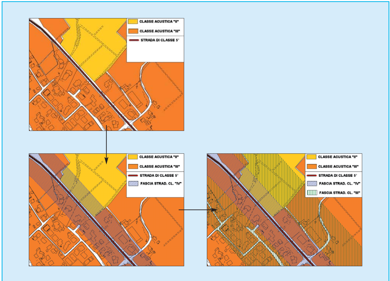
Figura 5: Esempio di zonizzazione tronco stradale di classe 5°, comune di Azzano Decimo.
